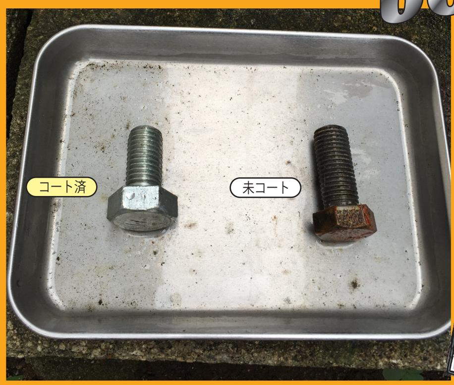
風雨にさらされ続ける屋外のボルトを、サビから強力にガード
